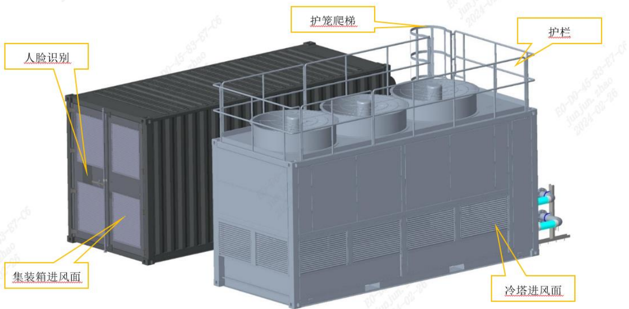
图 5-2 集装箱水冷系统外部视图
