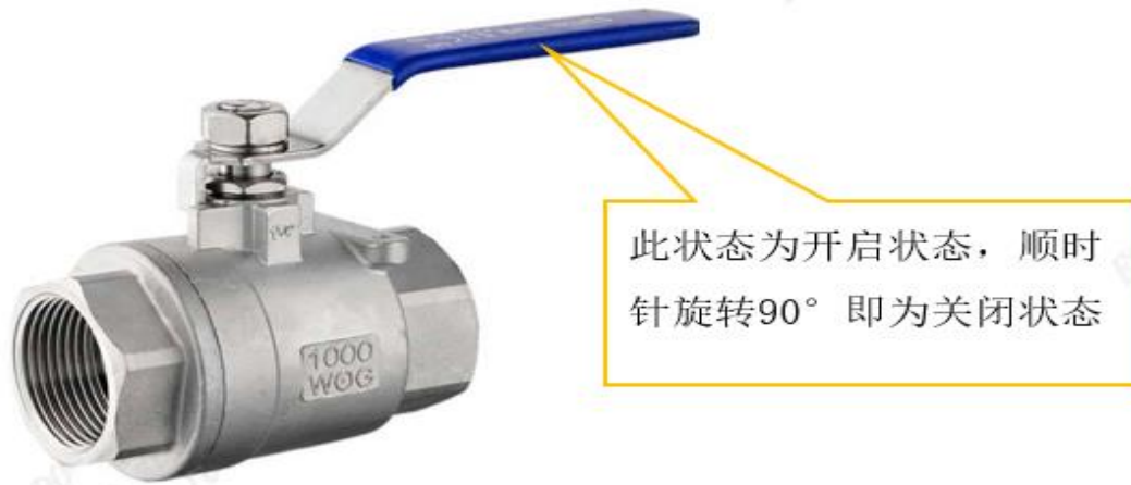
图 7-7 阀门开启关闭示意图
